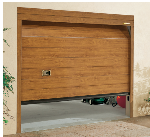
Vista esterna porta sezionale New Age XT Horizon, finitura liscia. Pannelli trattati esternamente con vernice superpoliestere "effetto legno" tinta noce chiaro. La maniglia art. 64 è optional. Interno pannelli gofrato stucco bianco simil Ral 9016.
