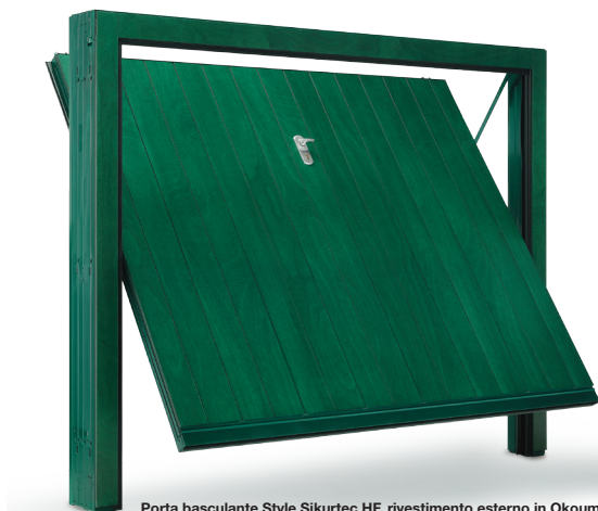
Porta basculante Style Sikurtec HF, rivestimento esterno in Okoumé multistrato pantografato a doghe verticali, passo da 170 mm. La predisposizione alla motorizzazione HF, il trattamento completo in tinta 4, la guarnizione inferiore in gomma, la placca e maniglia art. 98 sono optional.
