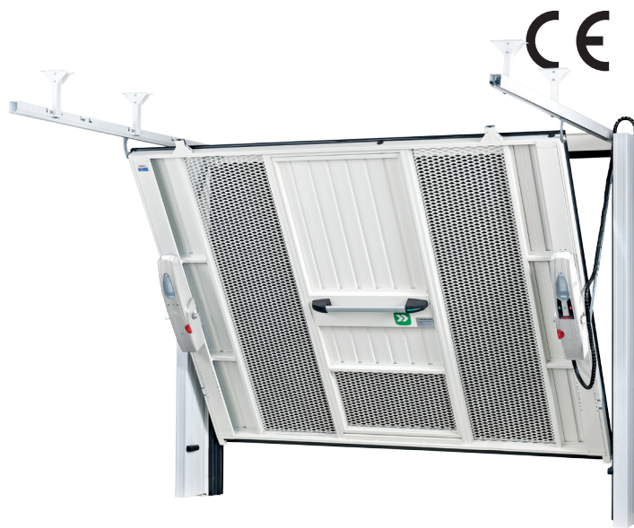
Vista interna Transit HF City Airon con automazione ERG-2 CITY e coppia di fotocellule interne premontate e precablate. La porta pedonale è optional, verniciatura Ral 9010 di serie.
