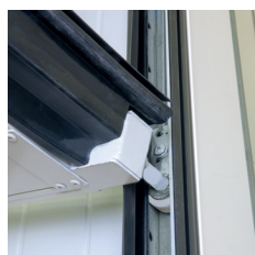
Dispositivo paracadute inserito nelle guide. Agisce in caso di rottura delle funi bloccando la caduta dell'anta mobile.
