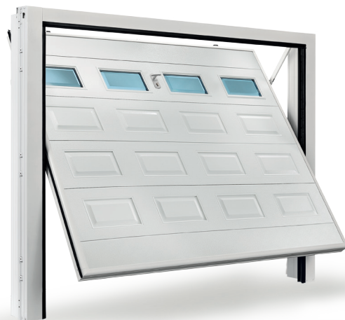
Porta basculante MyFusion Box, struttura Sikura HF, con bordi arrotondati, finitura gofrato stucco. Il modello è caratterizzato da profili geometrici rettangolari ottenuti attraverso una doppia profilatura della lamiera d'acciaio. La tinta simil Ral 9016 è di serie, gli oblò e la maniglia art. 98 sono optional.
