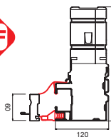
Sezione montante laterale, profilo anta mobile e guarnizioni di tenuta interne ed esterne.
